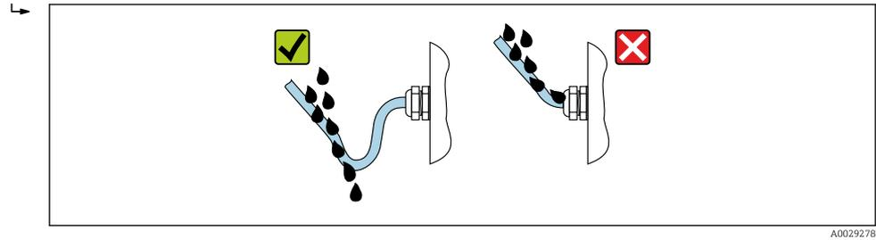
6. Die mitgelieferten Kabelverschraubungen bieten keinen Gehäuseschutz, wenn sie nicht verwendet werden. Sie müssen daher durch Blindstopfen ersetzt werden, die dem Gehäuseschutz entsprechen.
