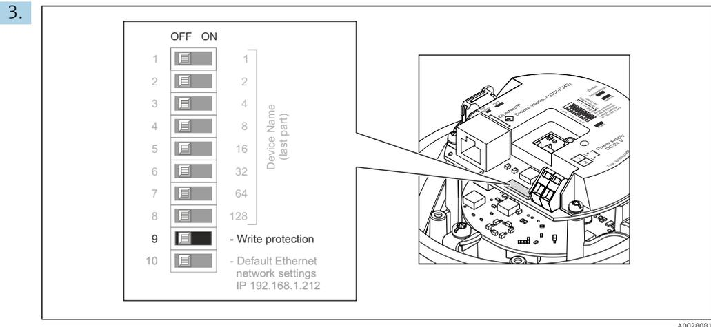
Verriegelungsschalter auf dem Hauptelektronikmodul in Position **On** bringen: Hardware-Schreibschutz aktiviert. Verriegelungsschalter auf dem Hauptelektronikmodul in Position **Off** (Werkseinstellung) bringen: Hardware-Schreibschutz deaktiviert.
