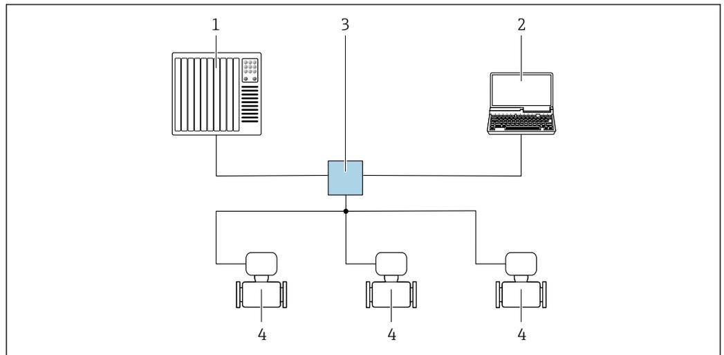
12 Möglichkeiten der Fernbedienung via PROFINET Netzwerk: Sterntopologie
