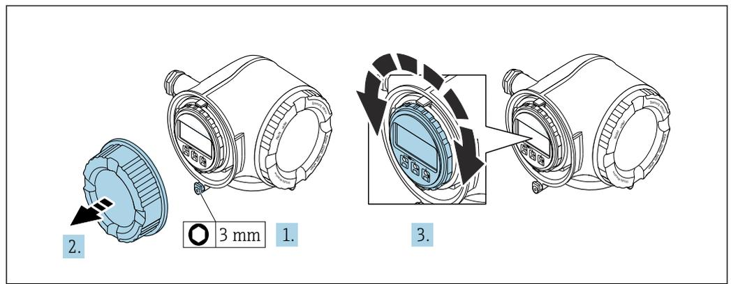
1. Je nach Geräteausführung: Sicherungskralle des Anschlussraumdeckels lösen.
