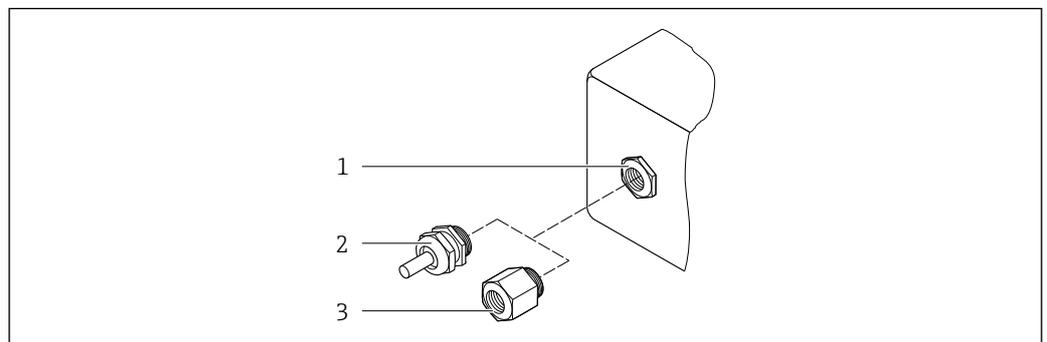
33 Mögliche Kabeleinführungen/-verschraubungen
