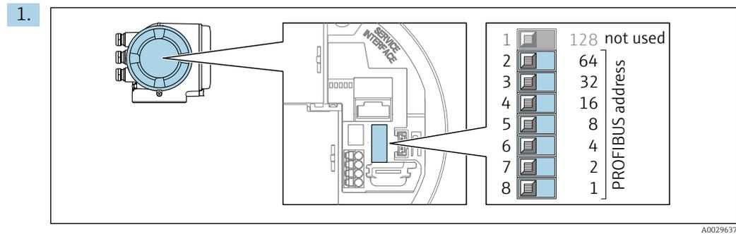
Die gewünschte Geräteadresse mittels der DIP-Schalter im Anschlussklemmenraum einstellen.
