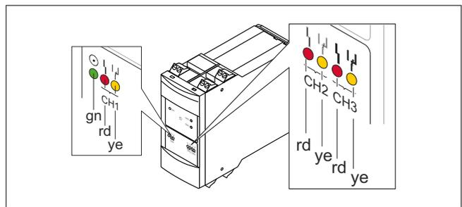
图 5 显示单元：发光二极管 (LED 指示灯)
