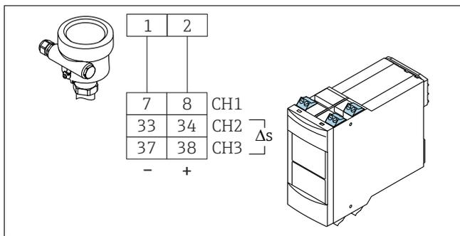
图 3 连接音叉开关和 Nivotester 信号转换器
