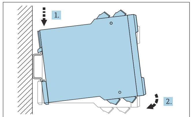
1 Montieren; Hut-schiene gemäß EN 60715 TH35-7.5/EN 60715 TH35-15
