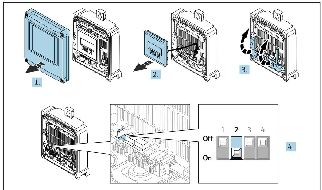
1. Die 4 Befestigungsschrauben des Gehäusedeckels lösen.
