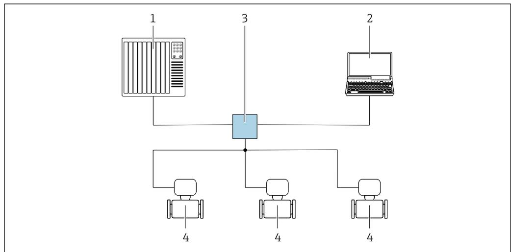
**30** Möglichkeiten der Fernbedienung via PROFINET Netzwerk: Sterntopologie
