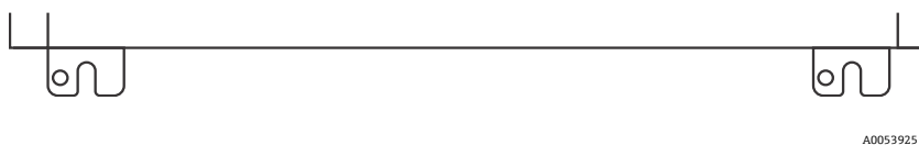
Figura 7. Linguette di montaggio inferiori scanalate della custodia
