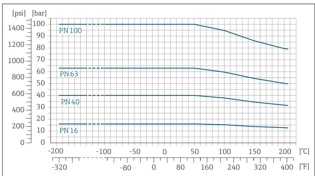
**31** Mit Flanschwerkstoff 1.4404 (F316/F316L)
