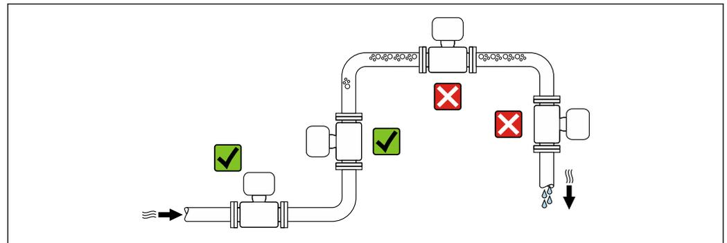
Um Messfehler aufgrund von Gasblasenansammlungen im Messrohr zu vermeiden, folgende Einbauorte in der Rohrleitung vermeiden:
