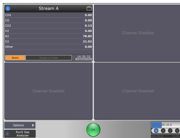
Abbildung 7. Raman RunTime Dashboard in einem vierkanaligen Raman Rxn2- oder Rxn4-Analysator (links) und Raman Rxn5-Analysator (rechts)
