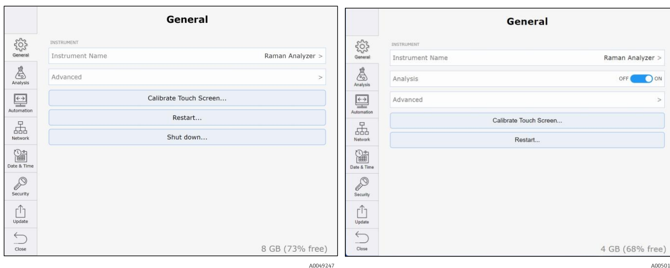
Abbildung 81. Anzeige zum Neustarten des Raman Rxn2 und Rxn4 (links) und Anzeige zum Neustarten des Raman Rxn5 (rechts)
