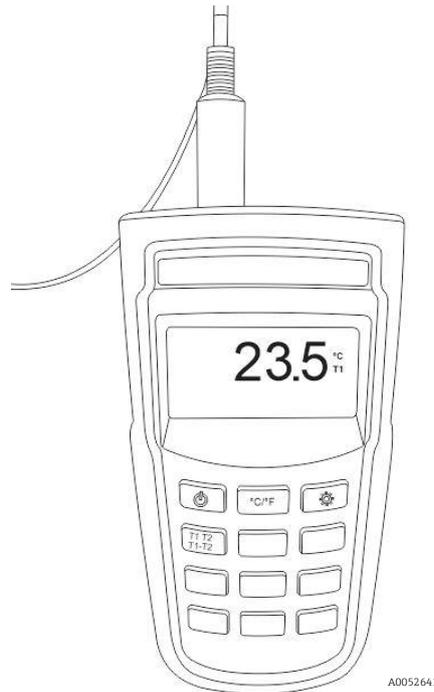
Abbildung 12. Thermometer in den Anschluss zur Temperaturmessung eingeführt
