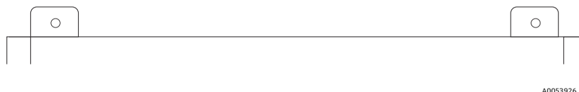
Abbildung 8. Obere Befestigungslaschen des Gehäuses
