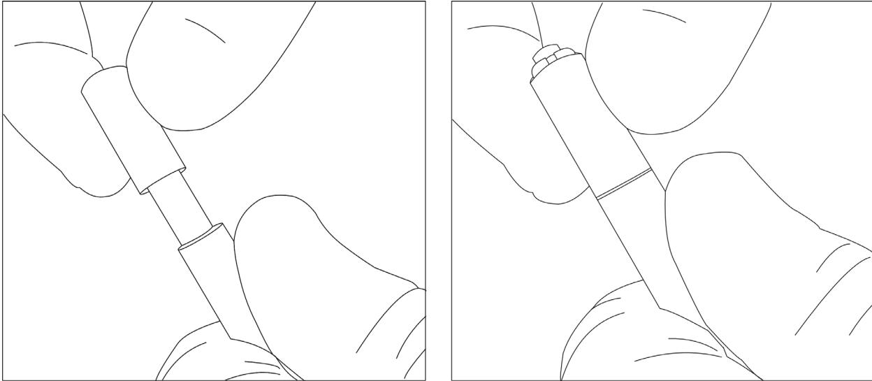
Abbildung 28. Trockenmittel auf dem Sleeve-Exsikkator montieren
