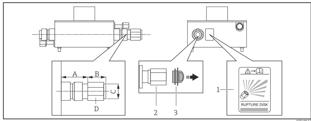
Abb. 7: Messaufnehmergehäuse mit Berstscheibe für definierte Mediumsabfuhr
