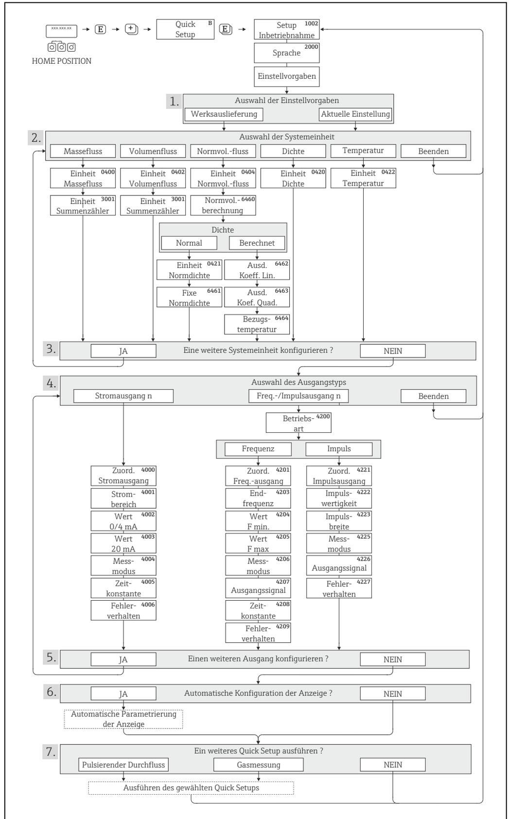
Abb. 24: Quick Setup für die schnelle Inbetriebnahme
