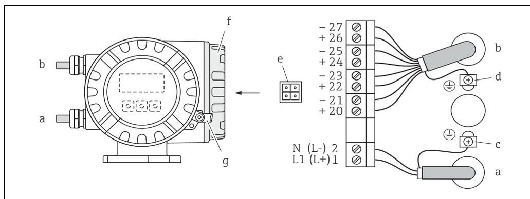
Abb. 14: Anschließen des Messumformers (Feldgehäuse), Leitungsquerschnitt max. 2,5 mm<sup>2</sup> (14 AWG)
