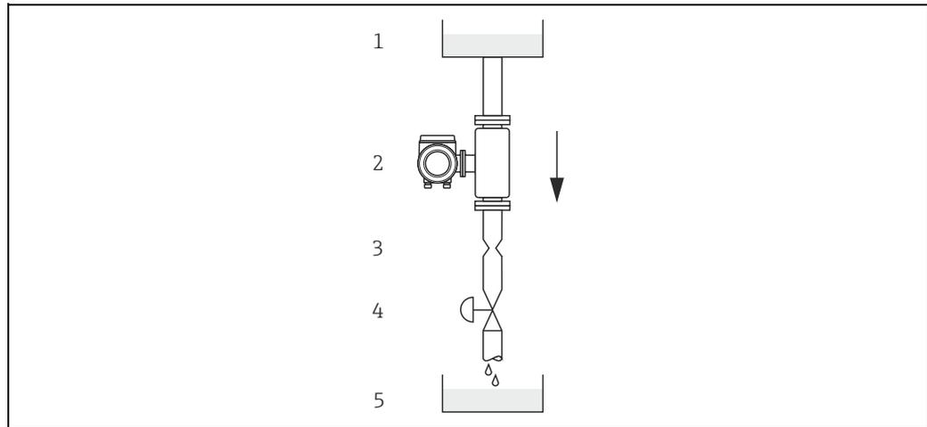
Abb. 5: Einbau in eine Falleitung (z.B. bei Abfüllanwendungen)
