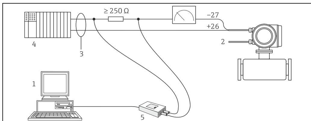
Abb. 17: Elektrischer Anschluss eines PC mit Bediensoftware
