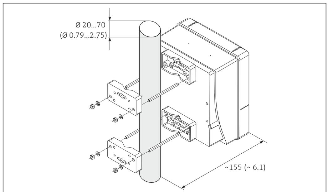
Abb. 11: Rohrmontage (Wandaufbaugehäuse)
