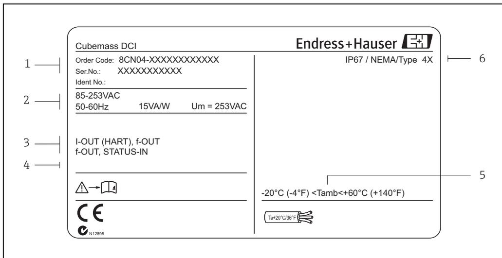
Abb. 1: Typenschildangaben für Messumformer (Beispiel)
