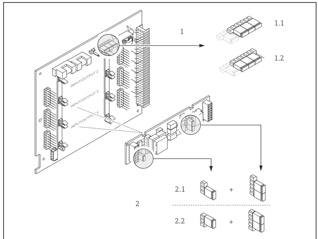
Abb. 28: Stromausgang konfigurieren mit Hilfe von Steckbrücken (I/O-Platine)
