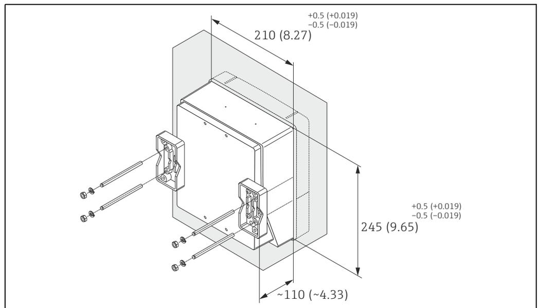
Abb. 10: Schalttafeleinbau (Wandaufbaugehäuse)
