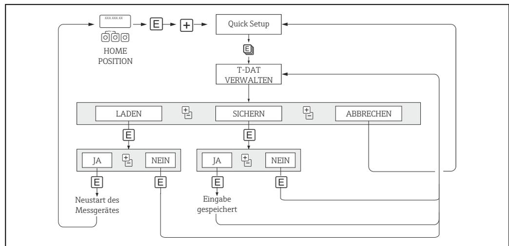
Abb. 27: Datensicherung/ -übertragung mit der Funktion T-DAT VERWALTEN
