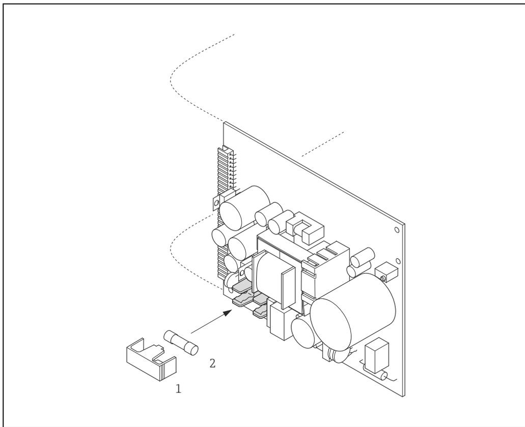
Abb. 35: Austausch der Gerätesicherung auf der Netzteilplatine
