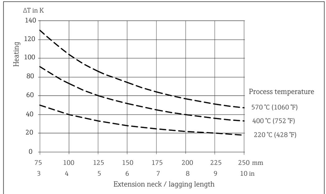
14 Chauffage de la tête de raccordement en fonction de la température de process. Température dans la tête de raccordement = température ambiante 20 °C (68 °F) +  $\Delta T$
