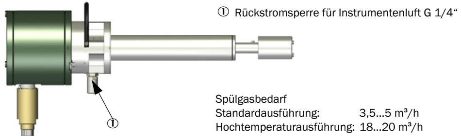
Abb. 27: Anschluss Spülgasversorgung bei Sende-Empfangseinheit
