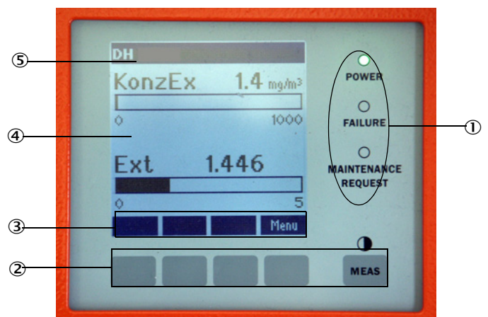
Abb. 58: Funktionselemente LC-Display Steuereinheit MCU
