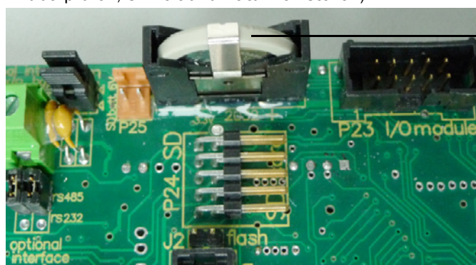
Abb. 68: Knopfzellenaustausch MCUDH Ex-3K
