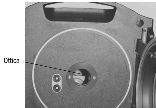
Fig. 35 - Ottica dell'unità SR (l'unità riflettore è analoga)
