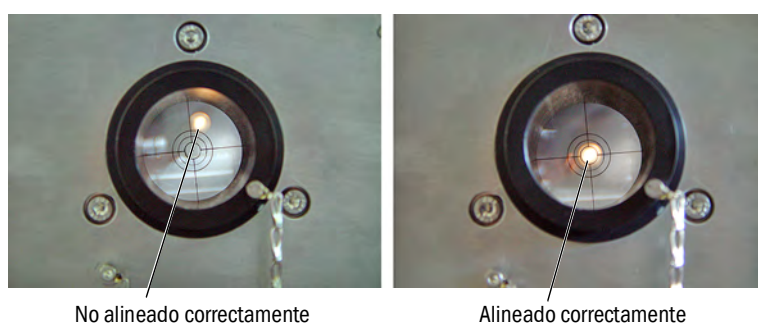
Fig. 7: Indicación de la alineación óptica - en la ventana del tubo de ajuste
