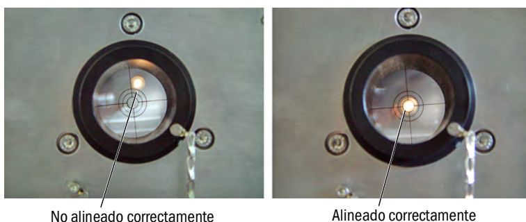
Fig. 20: Alineación óptica en la ventana del tubo de ajuste
