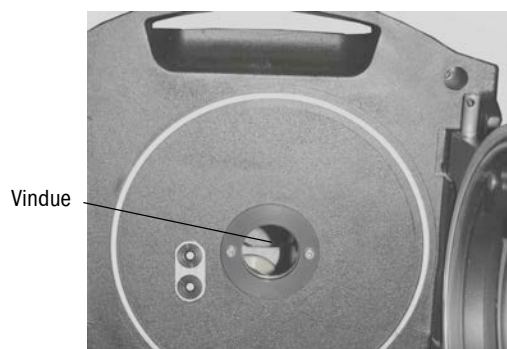
Fig. 35: Vindue på SM-enhed (reflektorenhed på tilsvarende vis)
