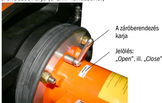
20. ábra: A záróberendezés karja (a GMP-lánzsánál)
