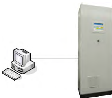
Fig. 8 MCS100FT collegato a un PC mediante Ethernet
