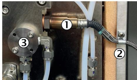
Figure 77: O<sub>2</sub> sensor
