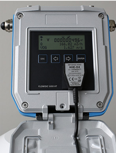
图 40 红外 /USB 连接件的的安装方向
