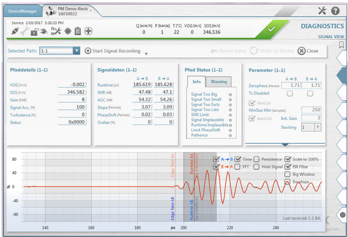
Fig. 46 Controllo delle fasi di zero
