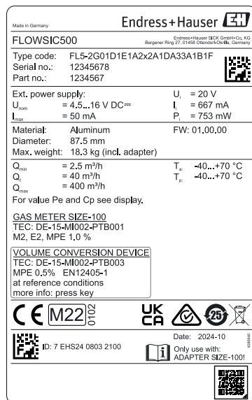
Bild 72 Metrologie- und Elektronik-Typenschild (Beispiel)
