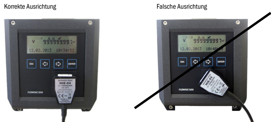
Bild 37 Ausrichtung des Infrarot-Adapters
