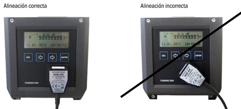
Fig. 37 Alineación del adaptador infrarrojo
