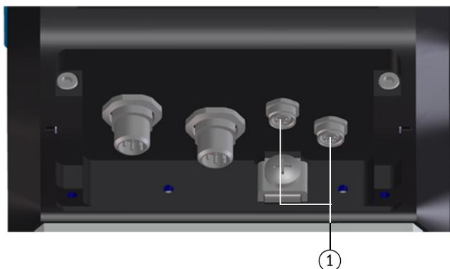
1 Выводы для датчика давления и для датчика температуры
