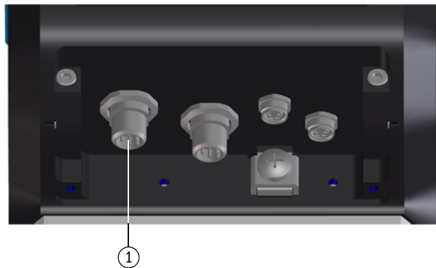
1 Alimentação elétrica externa e saída de sinais
