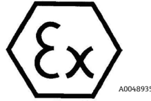
Figure 6. Label ATEX pour l'utilisation en zone explosible
