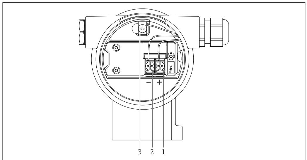
图 4 接线腔中的接线端子和接地端
