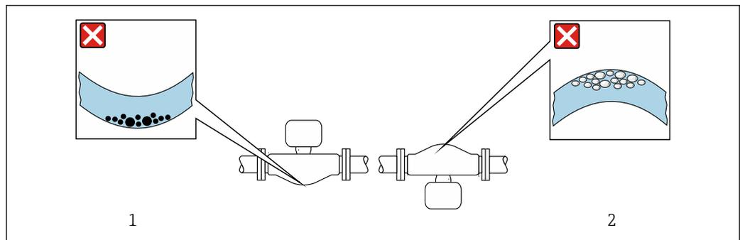
☒ 5 Position du capteur avec tube de mesure coudé
