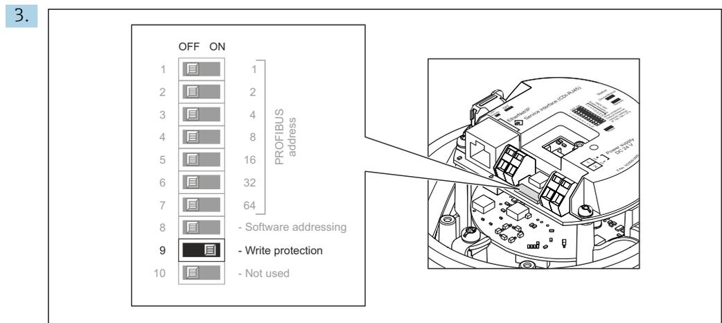
Mettre le commutateur de verrouillage sur le module électronique principal sur **ON** permet d'activer la protection en écriture du hardware. Mettre le commutateur de verrouillage sur le module électronique principal sur **OFF** (réglage par défaut) permet de désactiver la protection en écriture du hardware.
