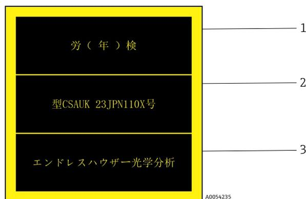
Figure 4. Label JPEX pour l'utilisation en zone explosible
