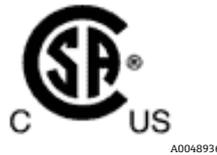
Figure 3. Label indiquant que l'équipement est agréé pour l'utilisation en zone explosible aux États-Unis et au Canada
