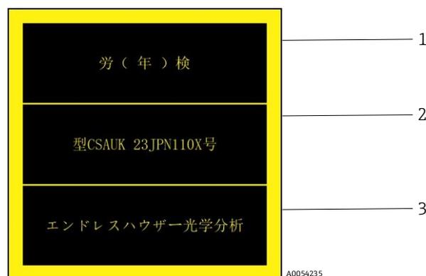
Figure 7. Label JPEX pour l'utilisation en zone explosible
