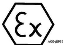
Figure 5. Label ATEX pour l'utilisation en zone explosible
