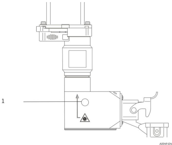
Figure 2. Emplacement de l'indicateur de verrouillage laser (1)
