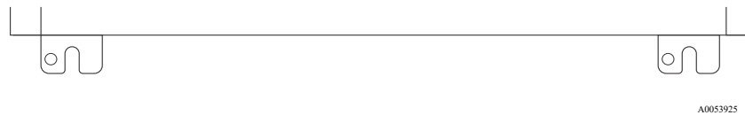
図 8. エンクロージャの溝付き下部取付タブ
