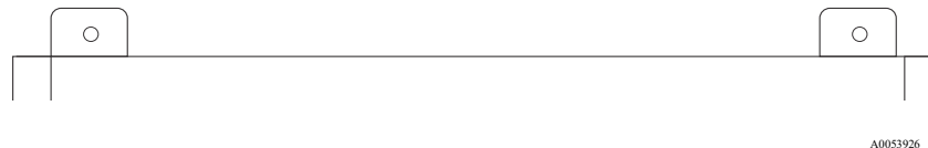
図 9. エンクロージャの上部取付タブ
