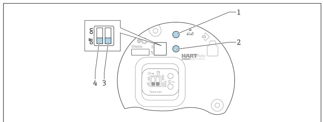
16 Bedientasten und DIP-Schalter auf dem HART Elektronikeinsatz
