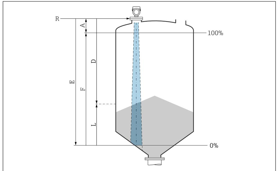
23 Paramètres de configuration pour la mesure de niveau dans les solides en vrac
