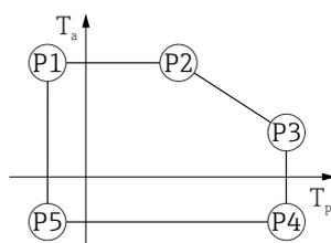
51 Корпус 316L; рабочая температура  $-40$  до  $+200$  °C ( $-40$  до  $+392$  °F)
