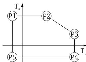
52 Корпус 316L; рабочая температура  $-40$  до  $+280$  °C ( $-40$  до  $+536$  °F)
