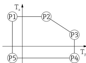
53 Корпус 316L; рабочая температура  $-40$  до  $+450$  °C ( $-40$  до  $+842$  °F)
