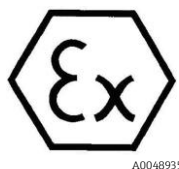
Figura 3. Etiqueta ATEX para uso em áreas classificadas
