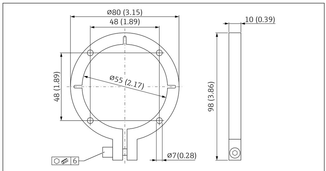
9 Brida de montaje para el sensor de varilla. Unidad de medida mm (in)
