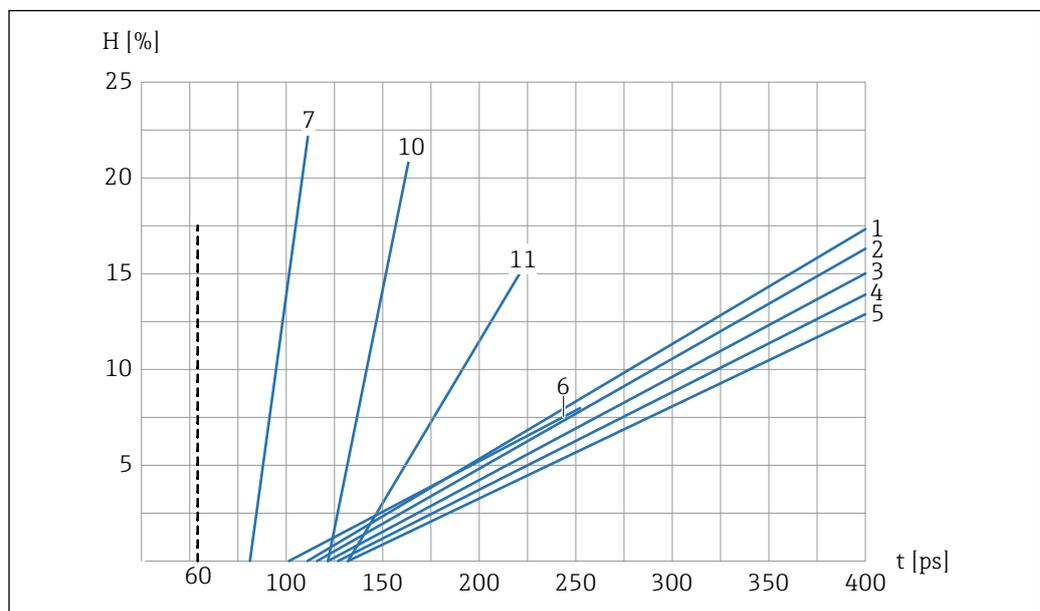
**19** Conjunto de curvas de calibración A (Cal.1, Cal.2, Cal.3, Cal.4, Cal.5, Cal.6, Cal.7, Cal.10, Cal.11)
