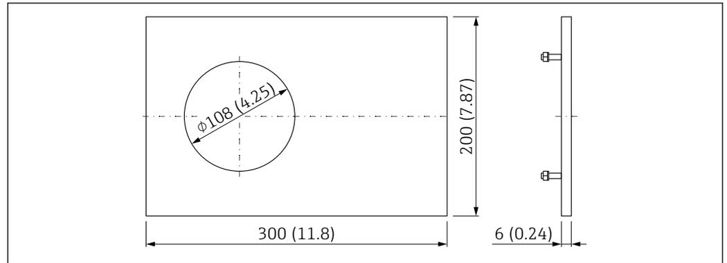
22 Placa deflectora, 1.4301, escotadura para el sensor de  $\varnothing 108$  mm (4,25 in). Unidad de medida mm (in)
