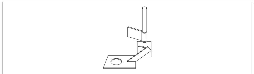
23 Soporte universal, 1.4301, con mecanismo de inclinación y cabezal de retención, escotadura para sensor de  $\varnothing 108$  mm (4,25 in)
