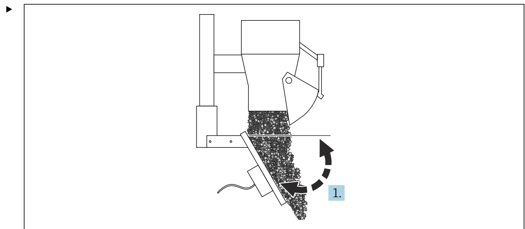
图 10 磨损性固体散料湿度测量：挡板相对于出料口的位置
