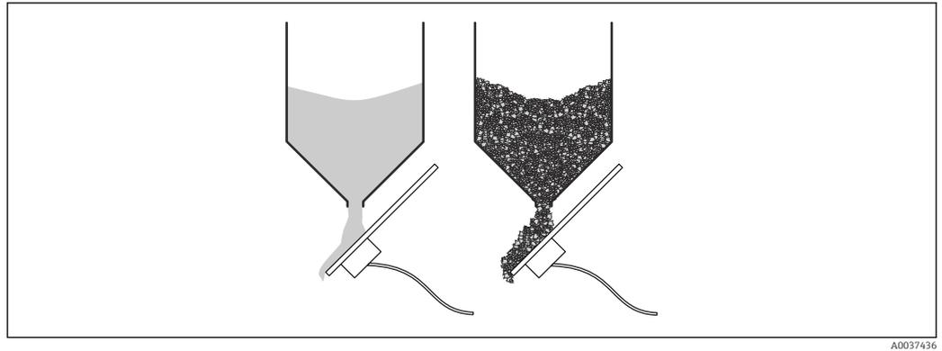
5 Instalación del sensor redondo para la medición de sólidos granulados bajo las compuertas de descarga del silo
