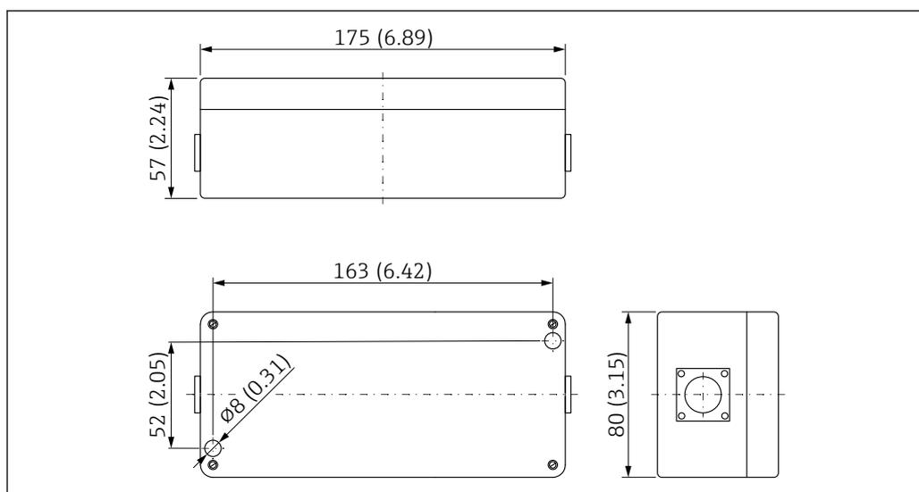
19 Dimensiones de la caja para el módulo de la electrónica remota. Unidad de medida mm (in)
