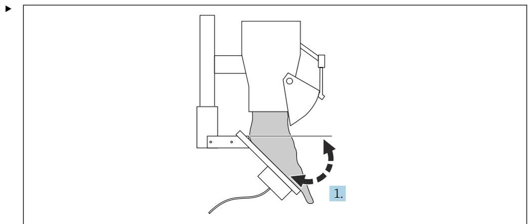
6 Cereal o pienso, posicionamiento de la placa deflectora-compuerta de abertura
