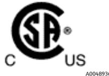
図 3. 米国およびカナダにおける危険場所での機器の使用が認可されていることを示すラベル
