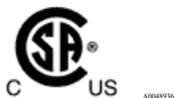
図 4. 米国およびカナダにおける危険場所での機器の使用が認可されていることを示すラベル
