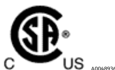
図 6. 米国およびカナダにおける危険場所での機器の使用が認可されていることを示すラベル
