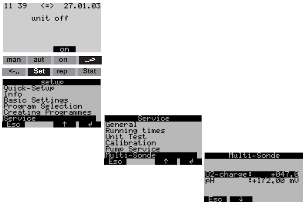
Obr. 32: Kontrola měření kyslíku (kontrolní systém snímače)
