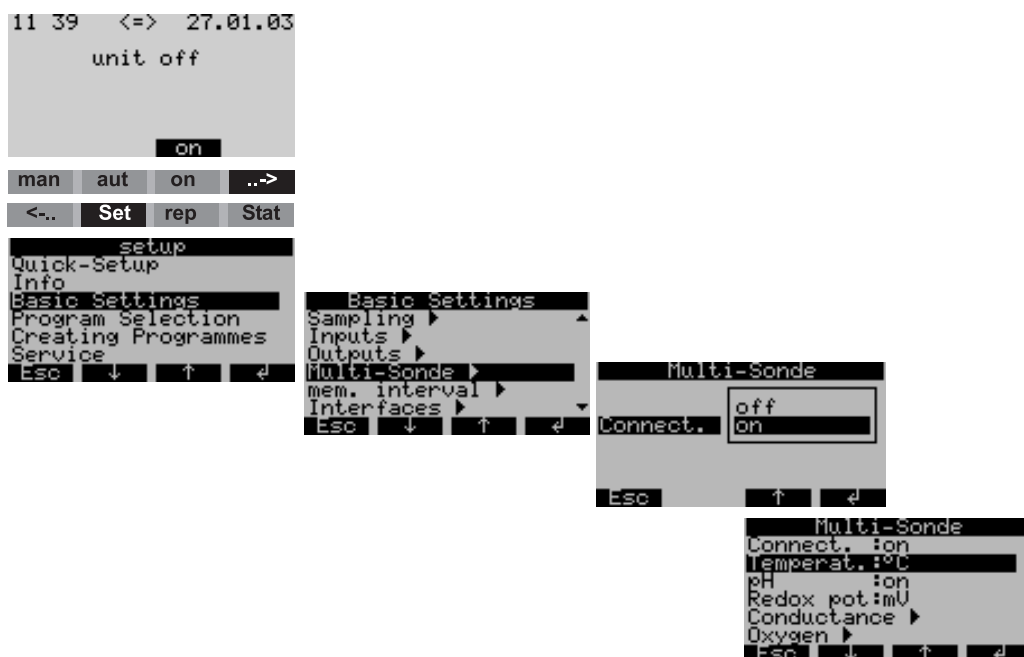
Obr. 33: Uvedení multiparametrové sondy do provozu (volitelně)
