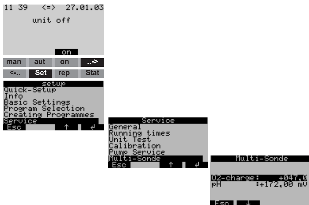
Obr. 28: Kontrola měření pH (kontrolní systém snímače)
