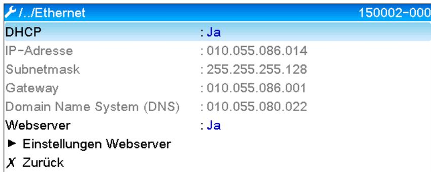
Abb. 3: Einstellungen der Ethernet Schnittstelle
