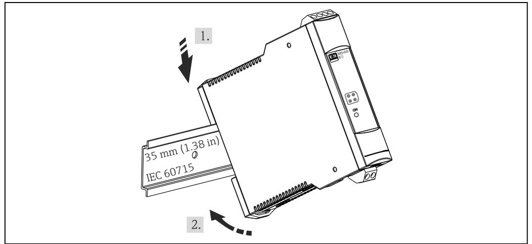
安装在 DIN 导轨上 - 参考图示步骤 1 和 2
