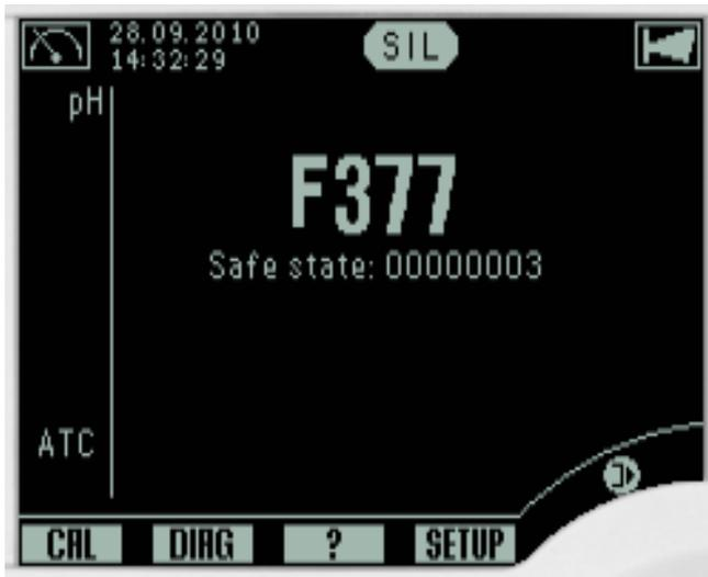
In diesem Beispiel lautet der Grund 00000003, was bedeutet: "Der Benutzer hat den SIL-Messmodus explizit deaktiviert (über einen sicheren Abgleich)".
