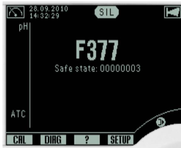
Die letzte Abbildung oben zeigt das Ergebnis der Temperaturkalibrierung: Es wurde in den aktiven sicheren Zustand gewechselt, und der Grund dafür lautet 00000003, was bedeutet, dass eine sichere Kalibrierung durchgeführt wurde.
